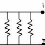
"ما علاقة الجهد الكهربائي لكل مقاومة مع الجهد بين (أ ، ب) ، هل يتجزأ التيار الداخل على دائرة التوازي بين المقاومات أم أن كل مقاومة يمر بها نفس التيار ؟
