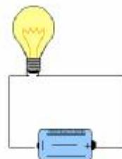
بعد توصيلك للأشياء السابقة تلاحظ أنه من خلال التوصيل يمكن إضاءة المصباح وهذه العملية تسمى الدارة الكهربائية
